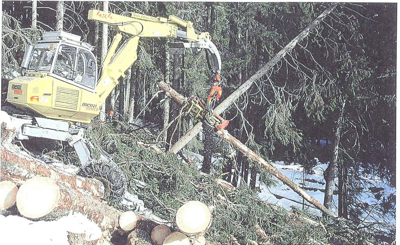
Foto 3: Holzschlag 2004, Mezi-Muck mit Vollernterkopf, genutzte Holzmenge 1600 m<sup>3</sup> (1 Seillinie). Preis ab Stock + Fr. 16.- / m<sup>3</sup>. (Foto R. Schwitter, Februar 2004, Nr. W/0030)
