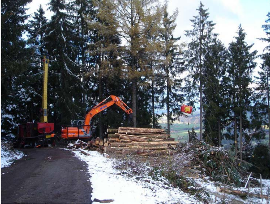
Teilmechanisiertes Vollbaumverfahren: Mobilseilkran + Baggerprozessor
