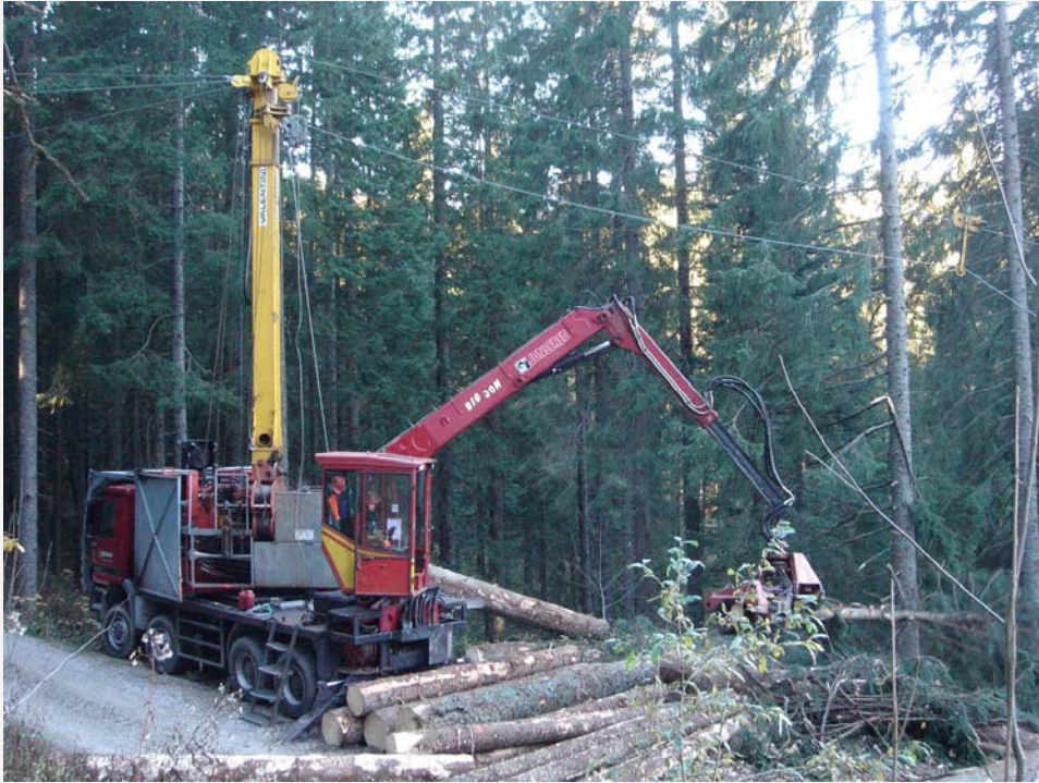
Teilmechanisiertes Vollbaumverfahren: Kombiseilgerät
