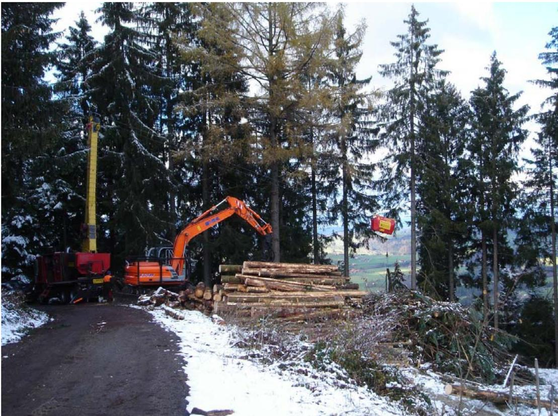
Teilmechanisiertes Vollbaumverfahren: Mobilseilkran + Baggerprozessor
